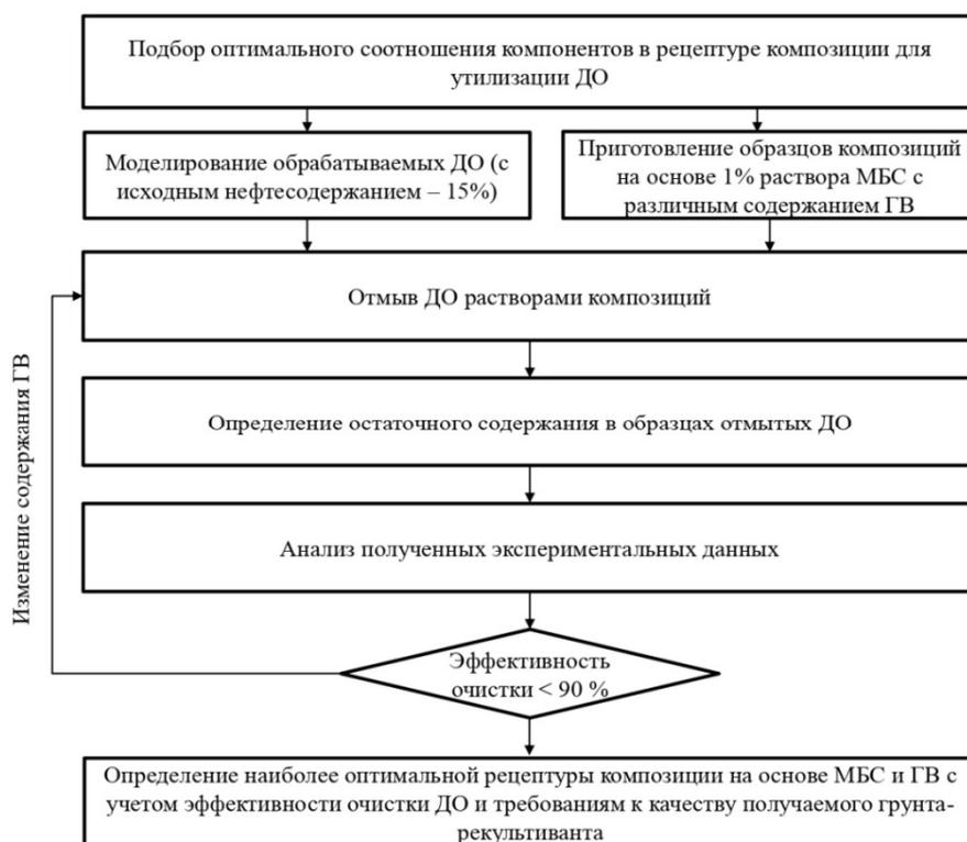
Рис. 1. Блок-схема проведения экспериментальных исследований по оптимизации рецептуры композиции
